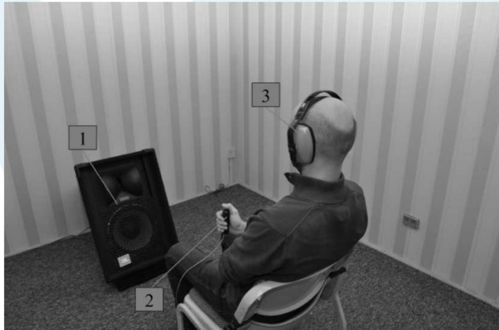
Zmodyfikowana (rozszerzona dla zakresu częstotliwości 10-16 kHz) metoda REAT
