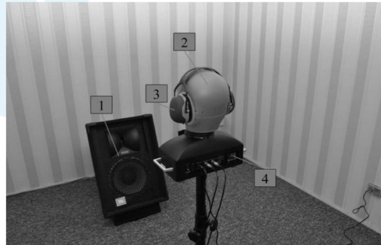
Pomiary z zastosowaniem testera akustycznego (G.R.A.S 45CB z mikrofonami G.R.A.S. 40BP)
