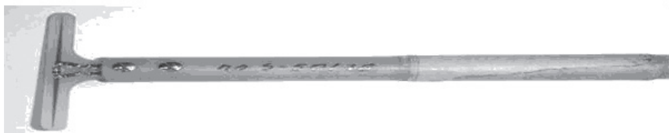
Ryc. 20. Wzorzec transferowy NIST na zakres 0,01–10 GHz.
