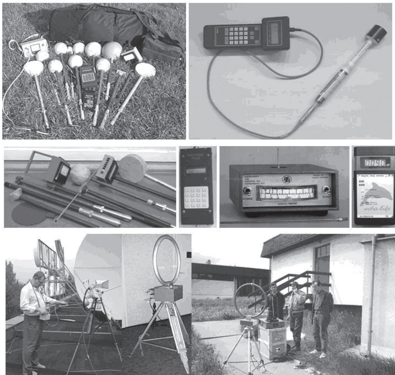
Ryc. 1. Przykładowe sondy pomiarowe i mierniki wykorzystywane w metrologii PEM.
