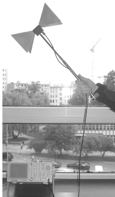
Ryc. 2. Układ do pomiaru PEM z analizatorem widma i anteną 0,3–1 GHz.
