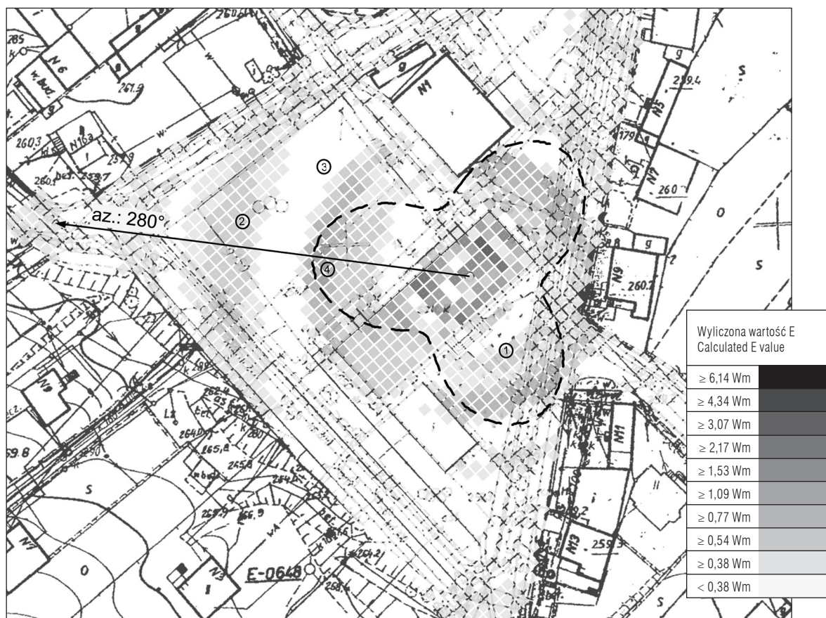
Ryc. 4. Symulacja rozkładu natężenia PEM w otoczeniu stacji bazowej. Fig. 4. Simulation of EMF intensity distribution in the base station surrounding.
