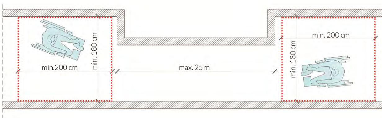
Rys. 26 Poszerzenia ciągów komunikacyjnych niezbędnych do minięcia się dwóch wózków
