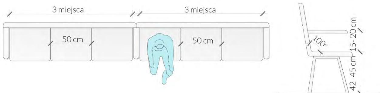
Rys. 28 Wytoczne i wymiary dotyczące ławek
